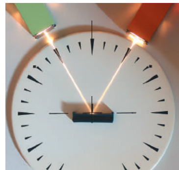
Рис. 25.4. Демонстрація оборотності світлових променів: відбитий промінь іде шляхом падаючого променя
