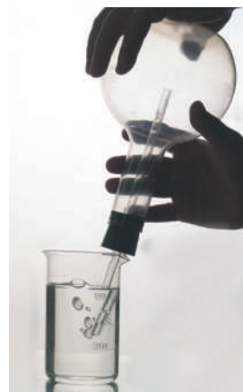
Рис. 2.1. Нагріваючись, повітря в колбі розширюється, і деяка його частина виходить із колби — біля отвору трубки утворюються бульбашки повітря
