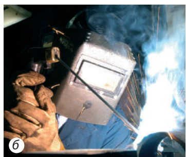
Рис. 40.9. Застосування дугового газового розряду для плавлення (а) та зварювання (б) металів
