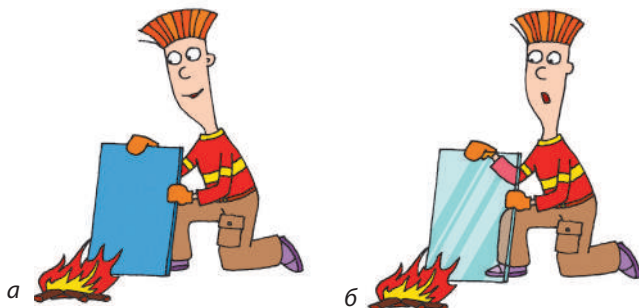
Рис. 7.3. Метал, який добре проводить тепло, краще захищає від гарячого полум'я, ніж скло, що є поганим теплопровідником
