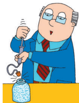
Рис. 4.5. Дослід, який підтверджує, що в ході виконання повітрям роботи його внутрішня енергія зменшується. Доказом цього є поява туману в посудині
