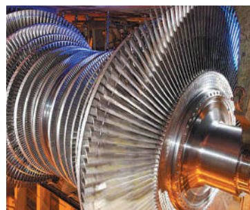
Рис. 17.3. У сучасних турбінах для максимального використання енергії пари застосовують кілька дисків з лопатями, які насаджено на один спільний вал
