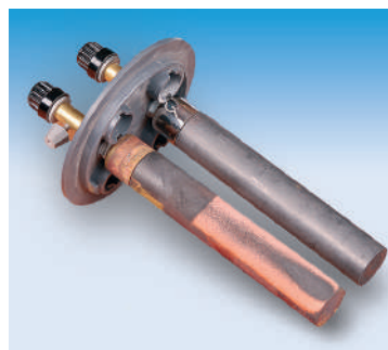
Рис. 37.5. Через кілька хвилин після початку пропускання струму через розчин хлориду міді поверхню катода вкрив тонкий шар міді
