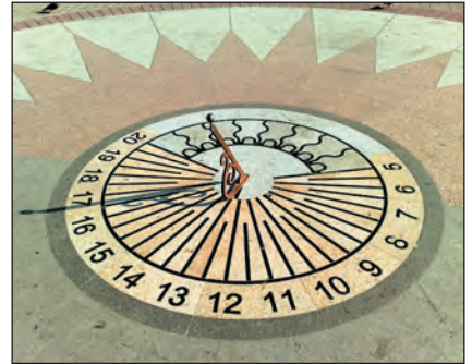
Мал. 1. Сонячний годинник. Зміна довжини тіні гномона (це може бути вертикальна жердина) вказує час доби вдень.
