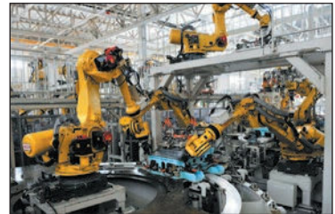
Мал. 2. Промислові роботи в цеху автомобільної компанії «Ніссан» (Японія). Більшість роботів використовують для зварювання, фарбування, установки дрібних деталей, проведення вантажно-розвантажувальних робіт. Найпотужніший робот здатен підняти вантажі до 1350 кг на висоту до 6 м.
