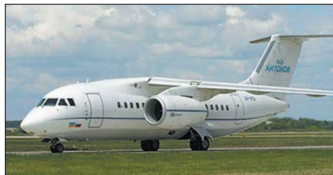
Мал. 4. Літак Ан-148 має два турбореактивні двигуни, розроблені й виготовлені на вітчизняних підприємствах (зокрема «Мотор Січ»).
