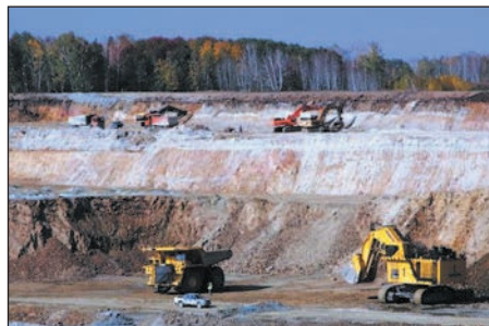
Мал. 2. На Іршанському гірничозбагачувальному комбінаті видобувають близько 400 тис. т ільменітових руд на рік. Із неї отримують понад 100 тис. т ільменітового концентрату.
