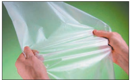
Мал. 6. Поліетилен — досить міцний матеріал. Плівку з нього можна згинати, м'яти, але важко порвати. Поліетилен не проводить електричний струм. Він є стійким до впливу кислот, лугів. Окремі різновиди поліетилену застосовуються у виробництві бронешитів і навіть броньованих автомобілів.
