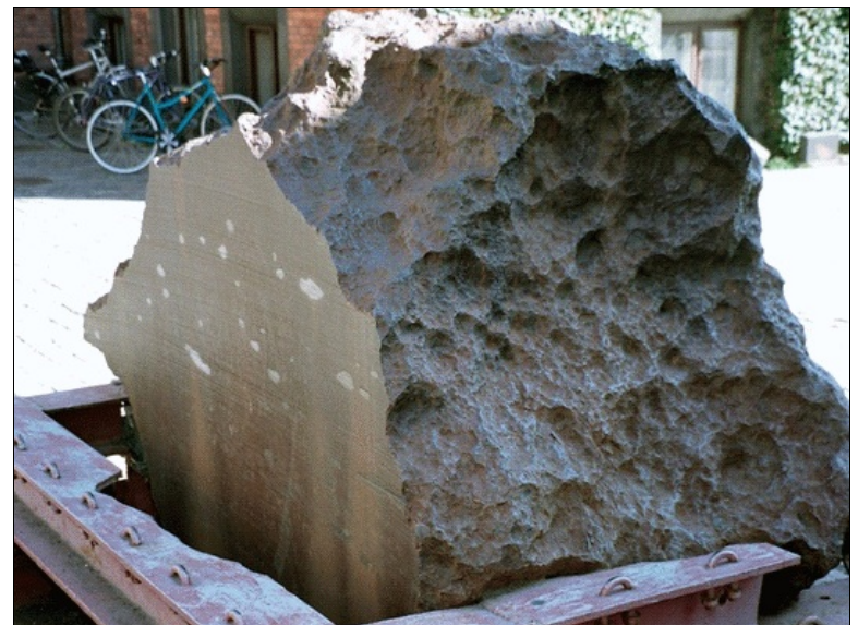
Jarnmeteoritturin Agpalilik, sum datt niður í Grønlandi, varð fluttur til Danmarkar í 1963 og er til skjals í garðinum við Geologisk Museum í Keypmannahavn. Hesin jarnklumpurin er ein ein-krystallur. Tað merkir, at óslitið samband er ímillum atomini í gittarbygnaðinum í honum. Tí vita vit, at hann í síni tíð er kólnaður ógvuliga spakuliga; 1 stig fyri hvørji 100.000 til millión ár. Helst hevur hann sitið í kjarnanum á onkrari smástjörnu væl bjálvaður av kilometratjúkkum jaðuri av steinsløgum. Seinni er smástjörnan farin í sor, og hesin klumpurin hevur fingið kós móti jørðini.
